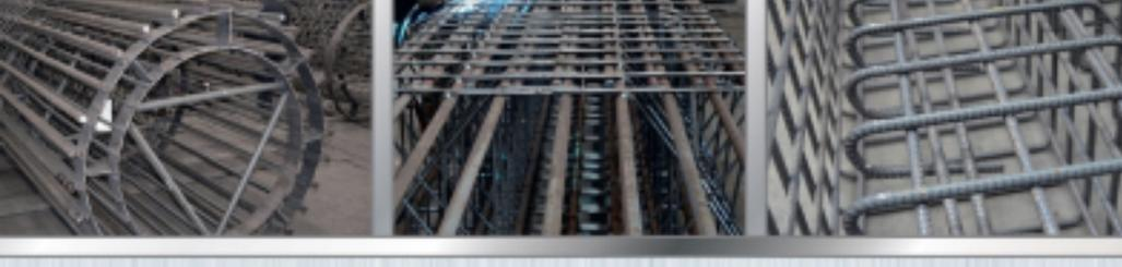
**ИЗГОТОВЛЕНИЕ ПЛОСКИХ И ПРОСТРАНСТВЕННЫХ АРМАТУРНЫХ КАРКАСОВ ЛЮБОЙ КОНФИГУРАЦИИ НА СБОРОЧНЫХ СТАПЕЛЯХ**
